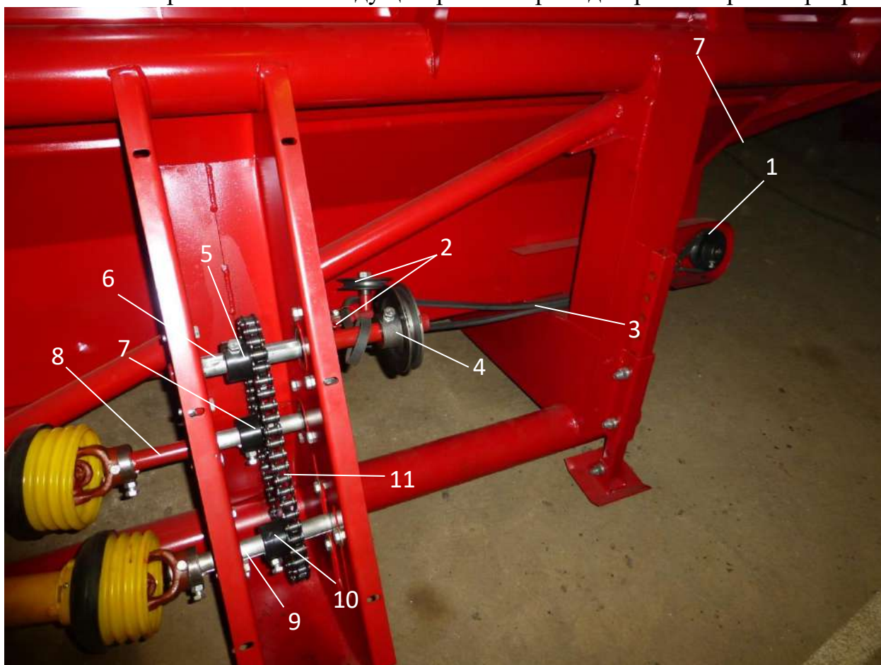
Рис.14 Привод правого транспортёра.
