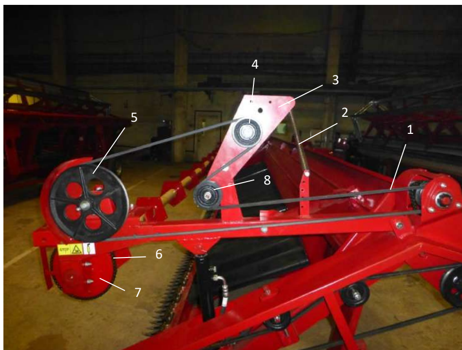
Рис. 7 Механизм привода мотовила
