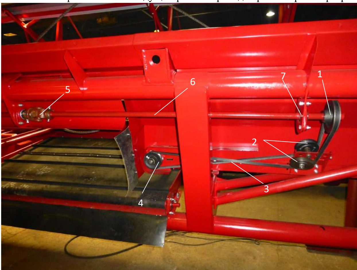
Рис.14 Привод правого транспортёра.
