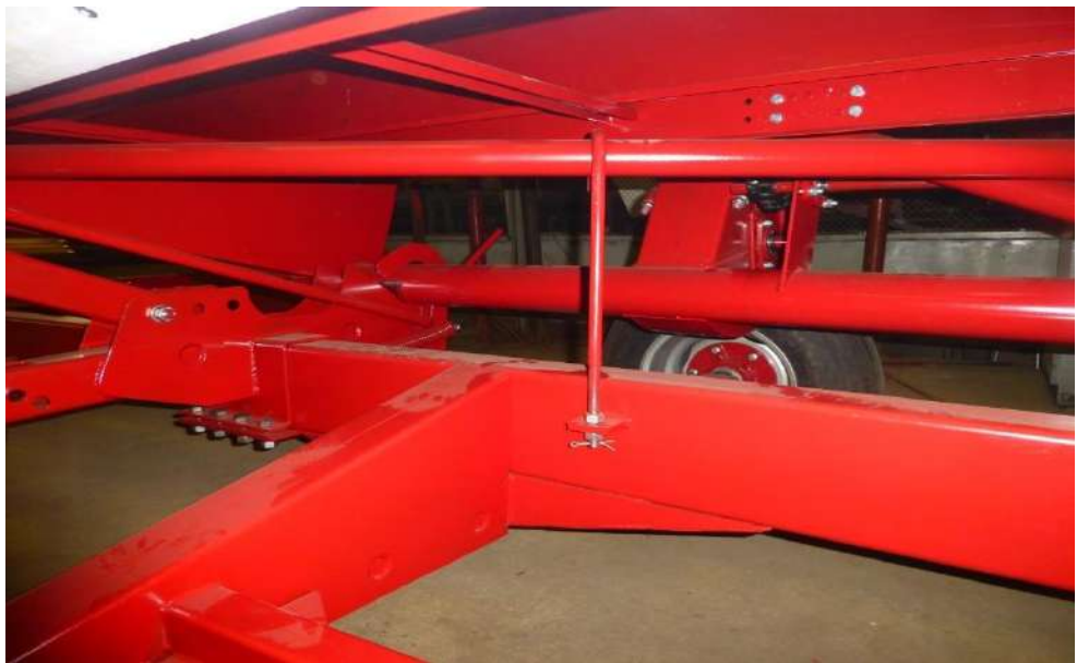
Рис.30 Крепление жатки на тележке.
