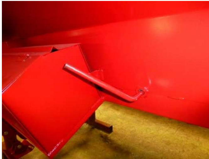
Рис.10 Рычаг натяжения ленточного транспортёра.
