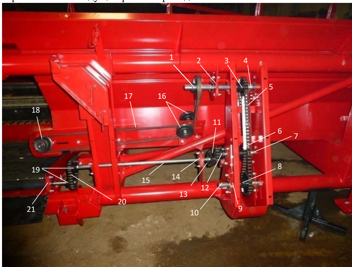
Рис.14 Привод правого транспортёра и центрального стола.
