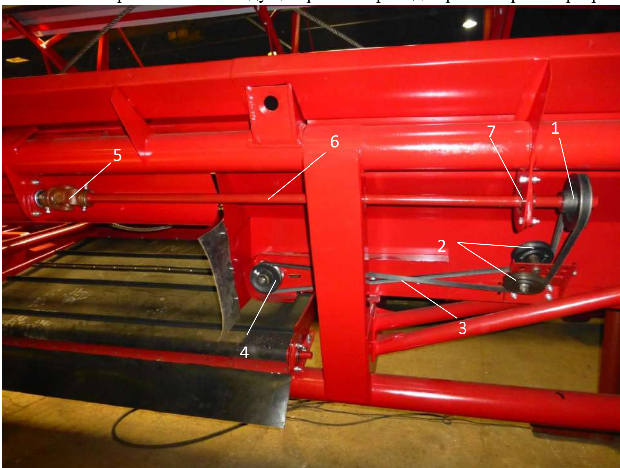
Рис.14 Привод правого транспортёра.
