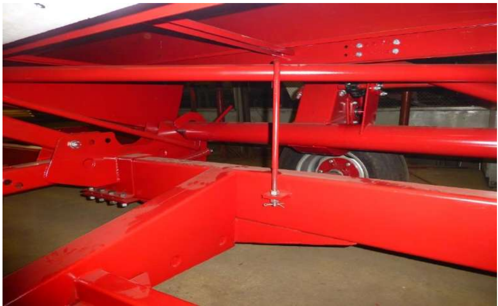
Рис.30 Крепление жатки на тележке.
