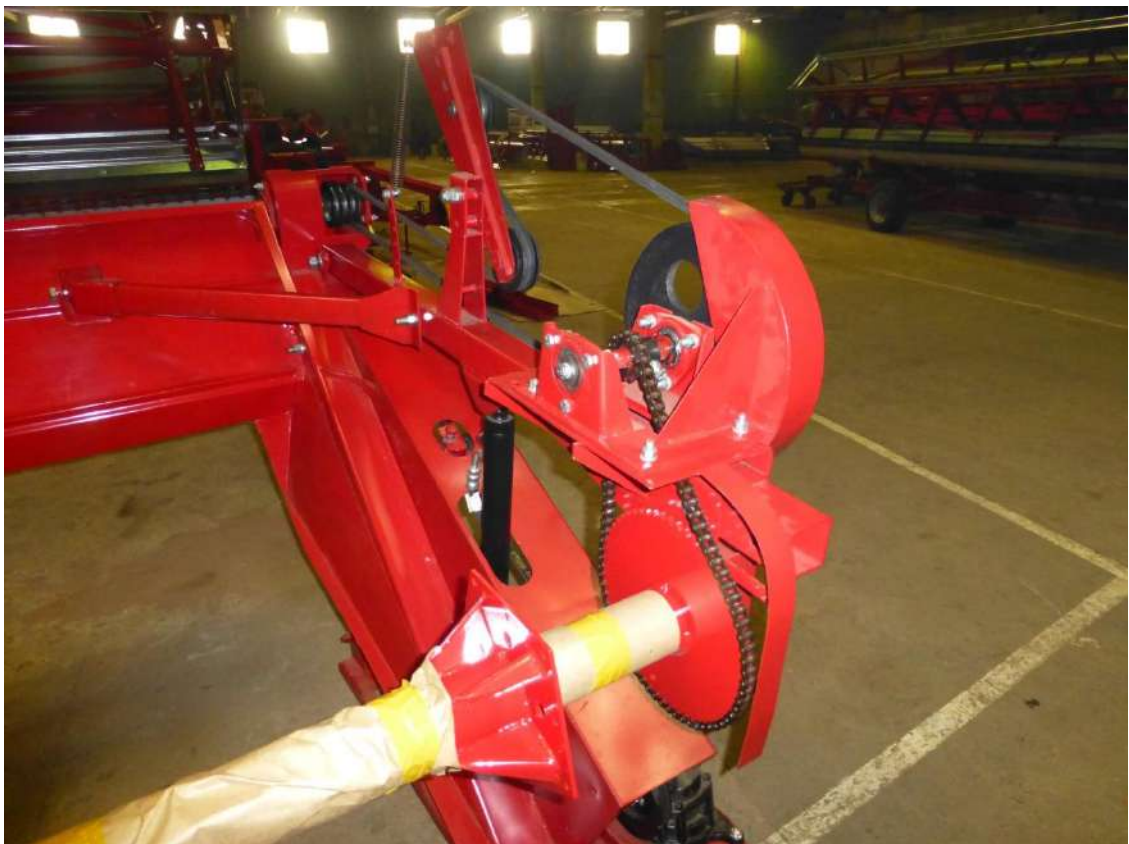
Рис. 6 Механизм привода мотовила
