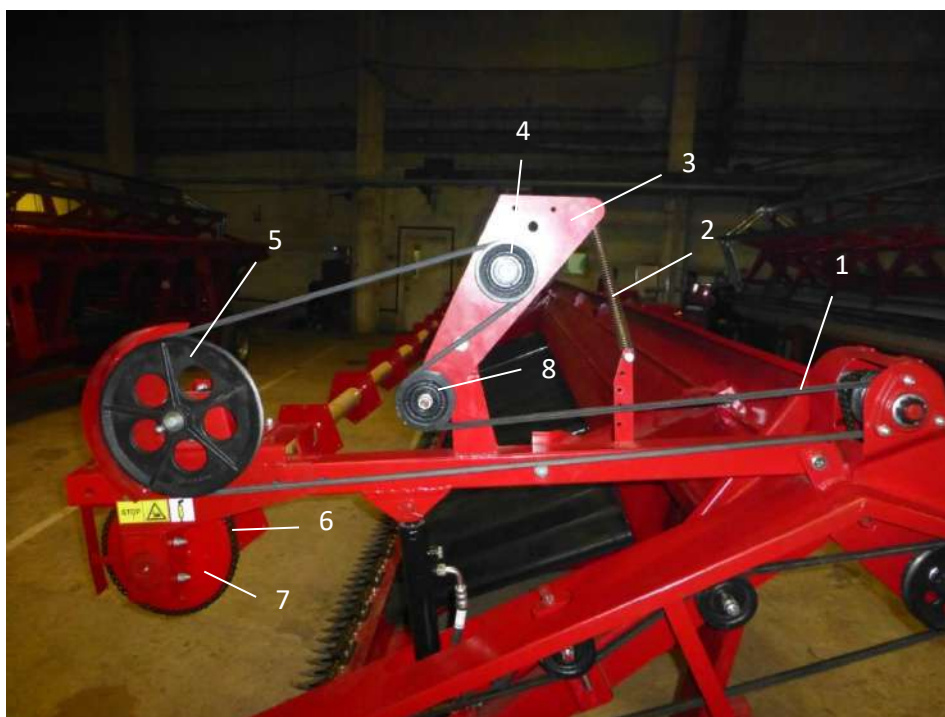
Рис. 7 Механизм привода мотвила
