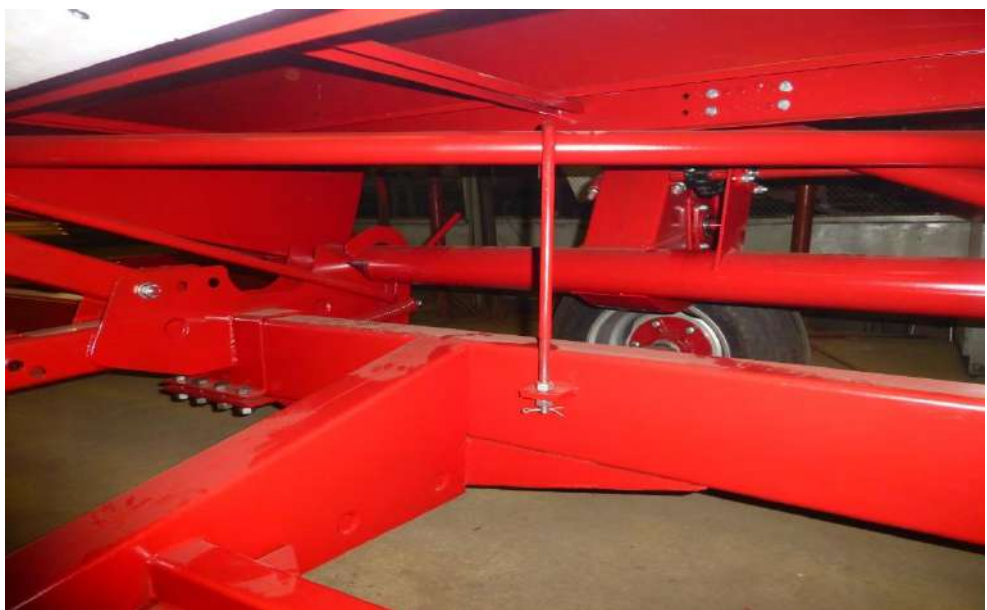
Рис.22 Крепление жатки на тележке.
