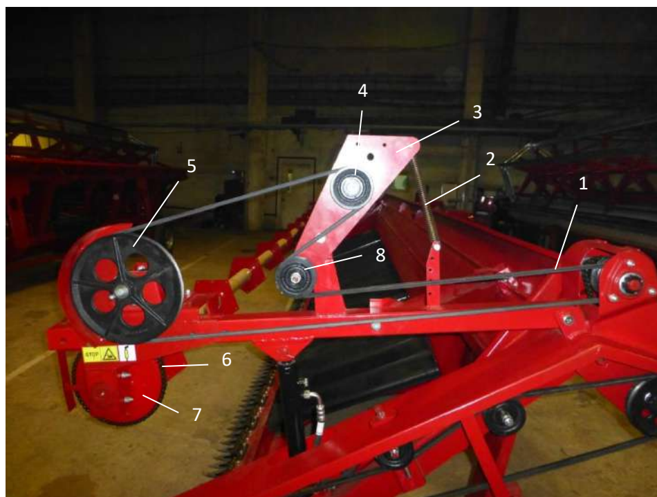
Рис. 6.3 Механизм привода мотовила
