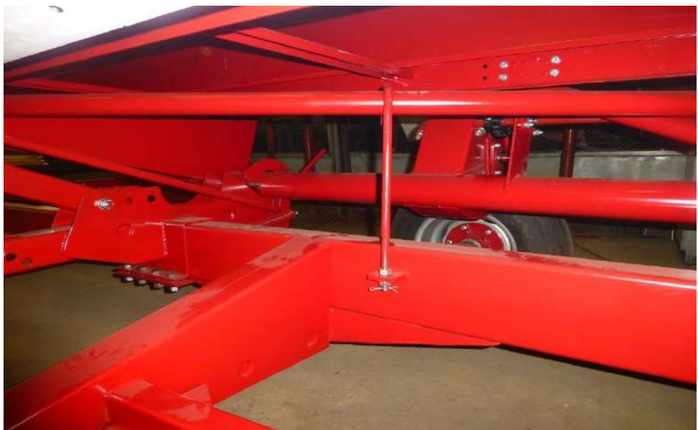
Рис.29 Крепление жатки на тележке.
