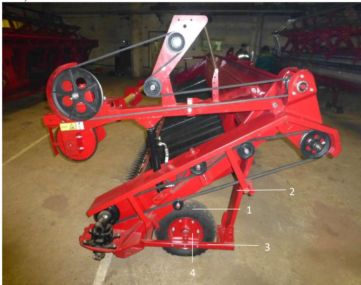
Рис. 3 – Опорные колеса 1- шина 5.00-10 В-19АМ Барнаул; 2- Стенка колеса ЖН.236 СБ; 3- Рама колеса ЖН.237 СБ; 4- диск колеса с\х;
