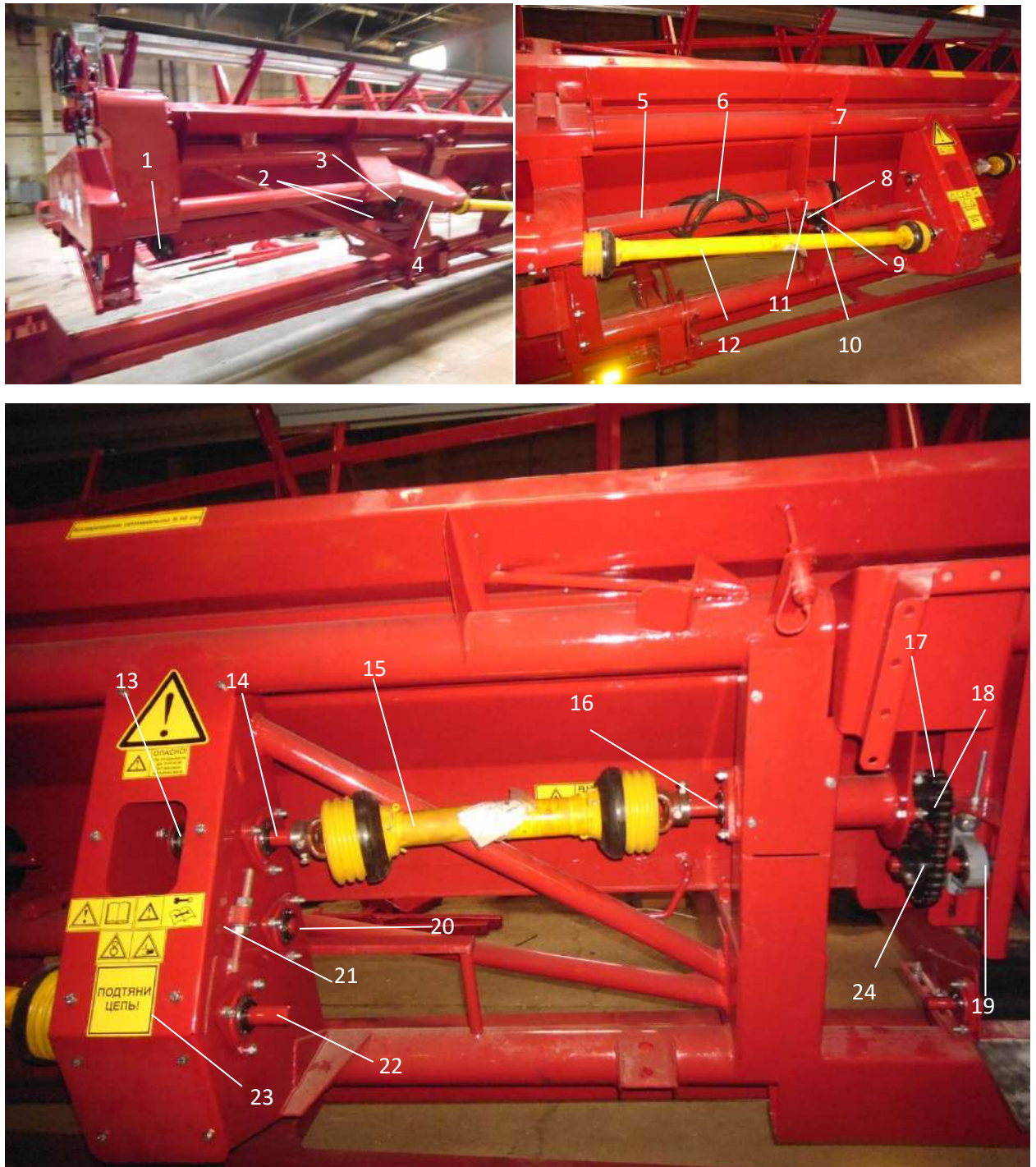
Рис.15 Привод левого транспортёра и битера жатки.
