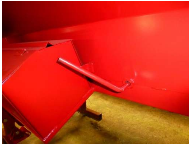
Рис.10 Рычаг натяжения ленточного транспортёра.
