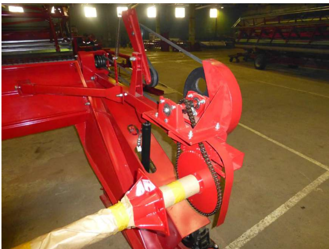
Рис. 6 Механизм привода мотовила
