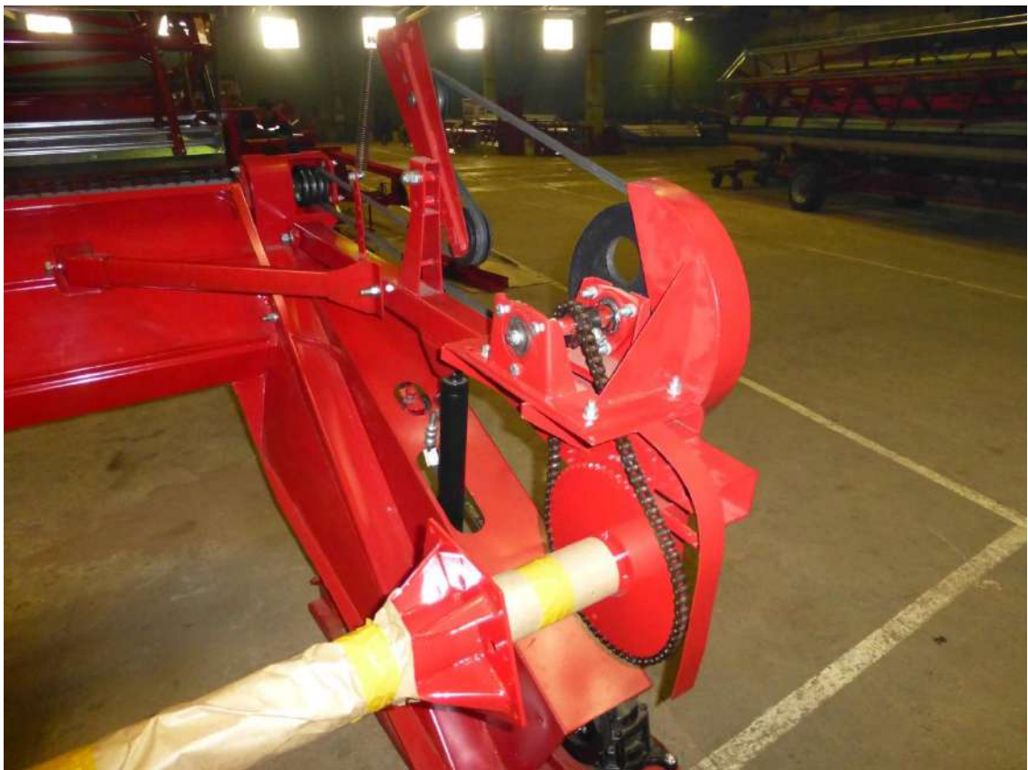
Рис. 6 Механизм привода мотовила
