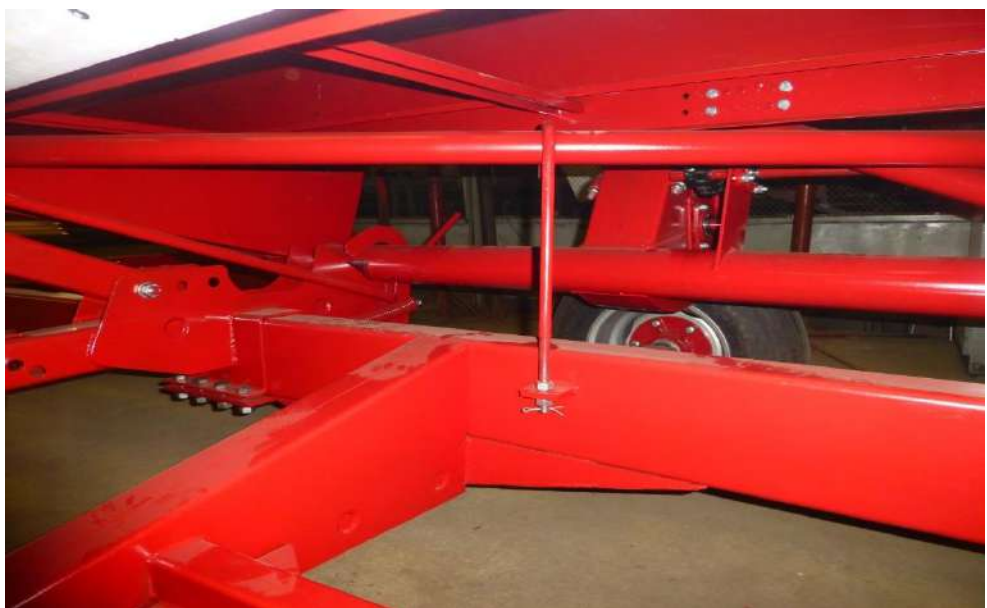
Рис.22 Крепление жатки на тележке.
