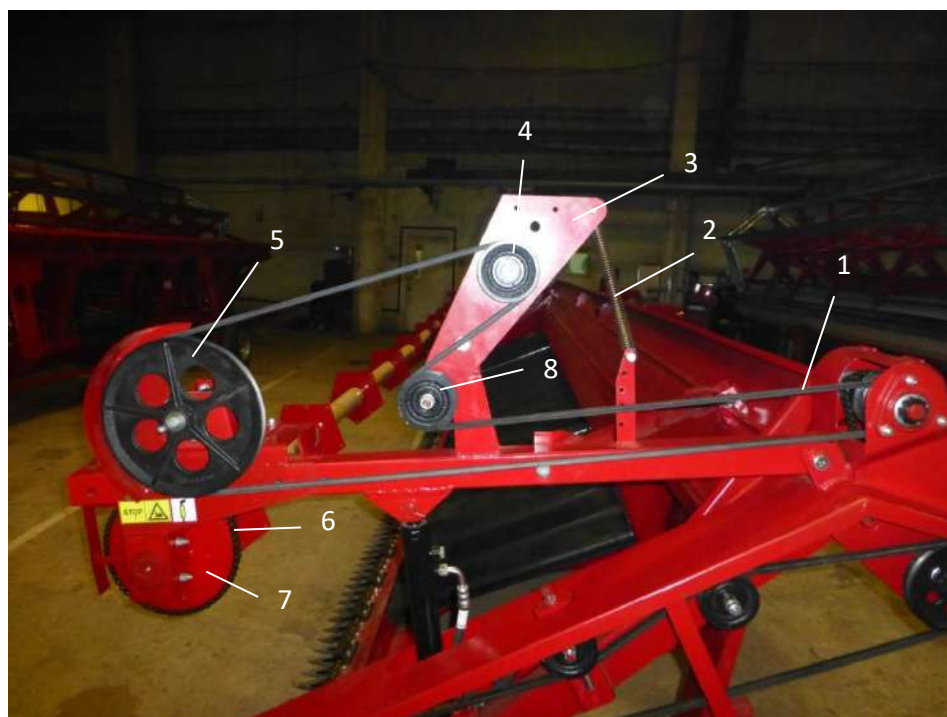
Рис. 6.3 Механизм привода мотовила
