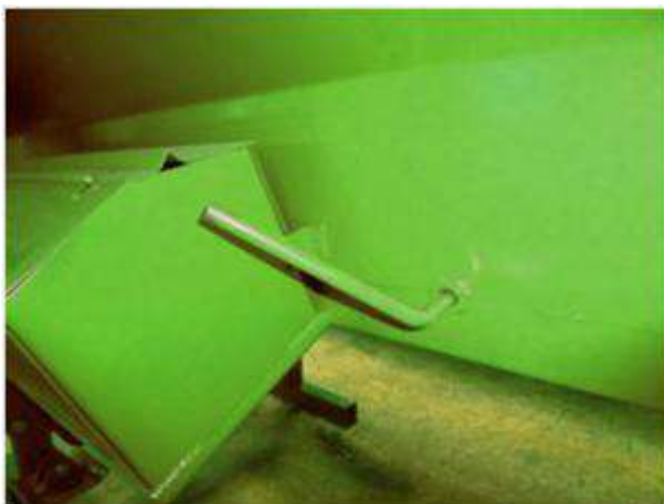
Рис.10 Рычаг натяжения ленточного транспортёра.
