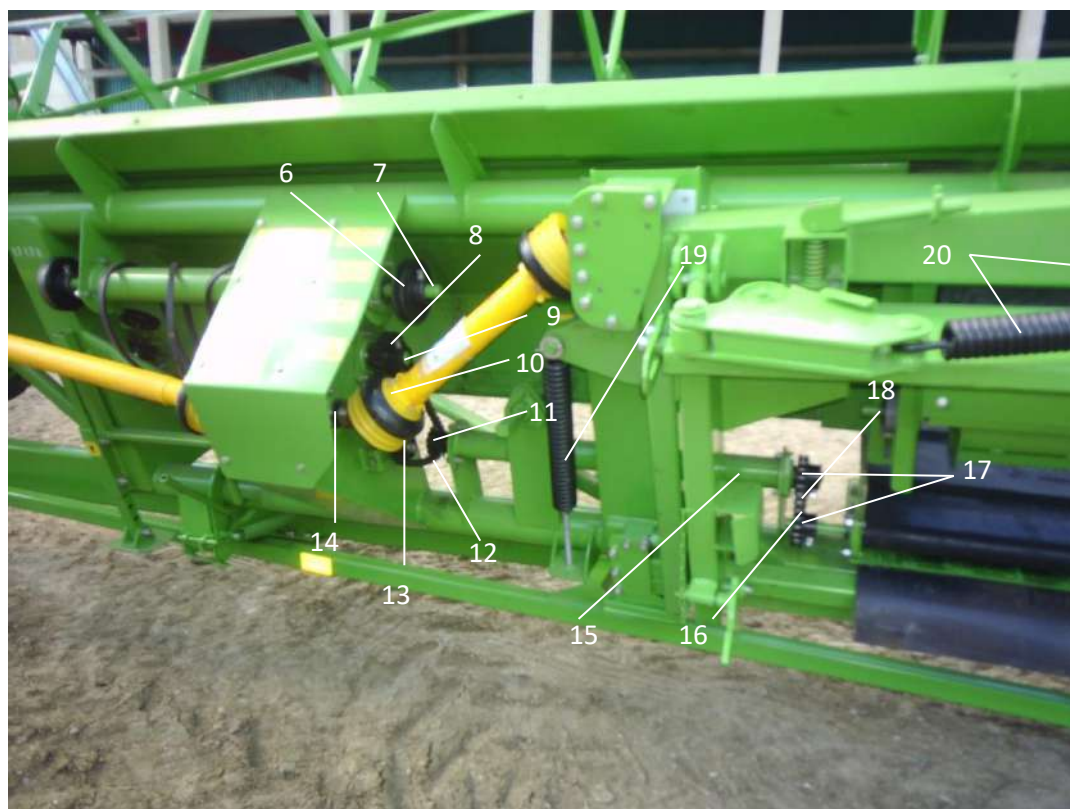
Рис.15 Привод левого транспортёра и центрального стола.
