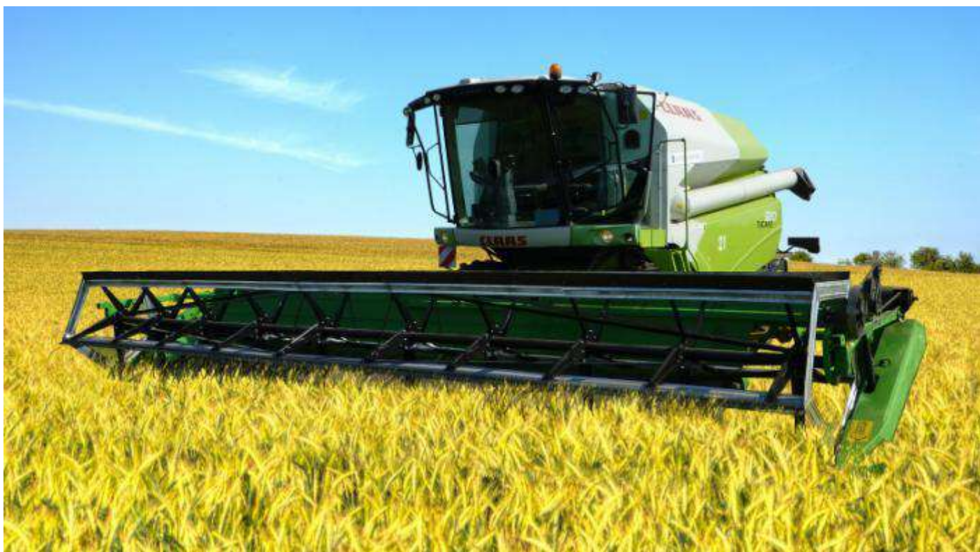
Рис.1 Общий вид комбайна Class Mega 350 с жаткой «ДОН МАР» ЖН-9У(Class Mega 350)
