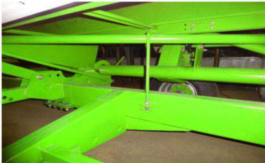
Рис.28 Крепление жатки на тележке.
