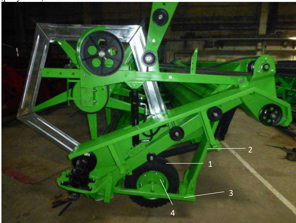
Рис. 3 – Опорные колеса 1- шина 5.00-10 В-19АМ Барнаул; 2- Стенка колеса ЖН.236 СБ; 3- Рама колеса ЖН.237 СБ; 4- диск колеса с\х;
