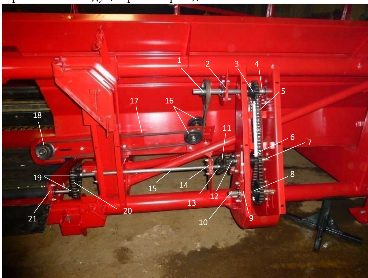
Рис.14 Привод правого транспортёра и центрального стола.
