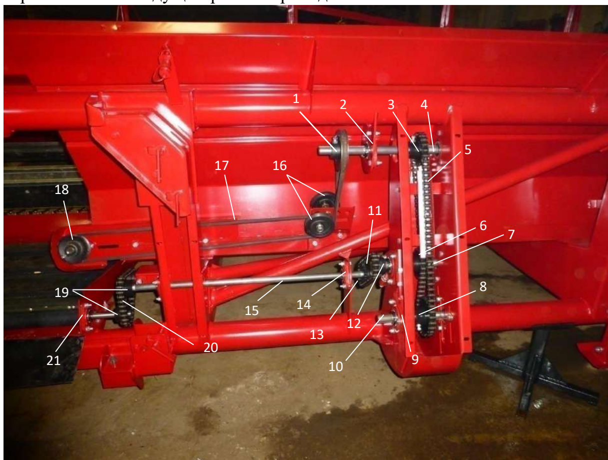
Рис.14 Привод правого транспортёра и центрального стола.
