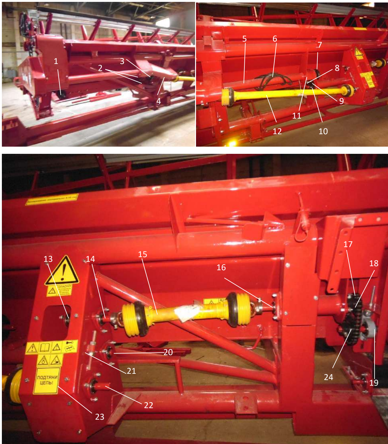
Рис.15 Привод левого транспортёра и битера жатки.
