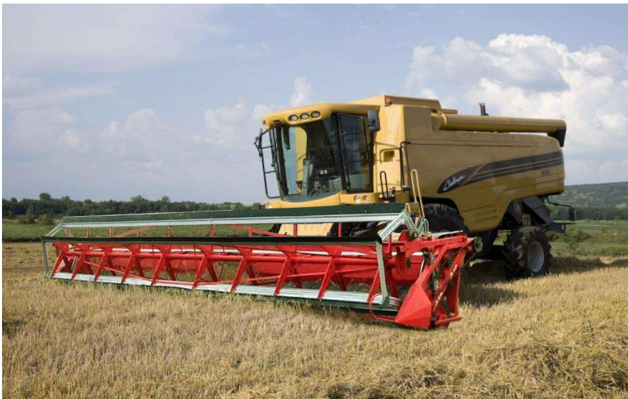
Рис.1 Общий вид комбайна Challenger с жаткой “Дон Мар” 12У(СН647)
