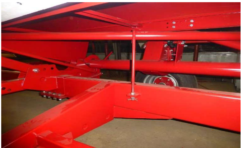
Рис.29 Крепление жатки на тележке.
