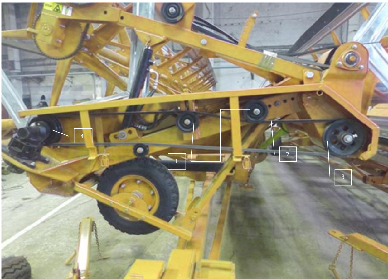
Рис.26 Привод режущего аппарата
