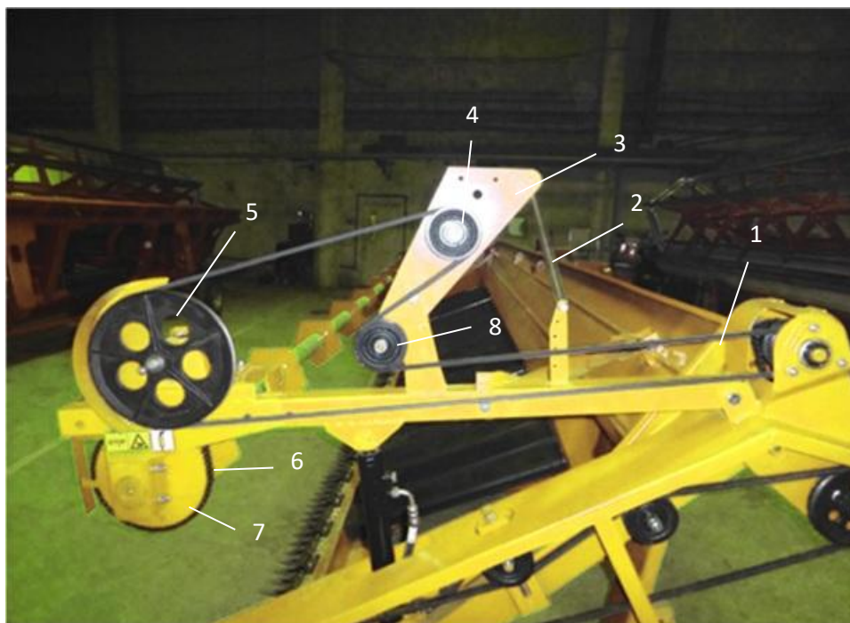
Рис. 7 Механизм привода мотвила
