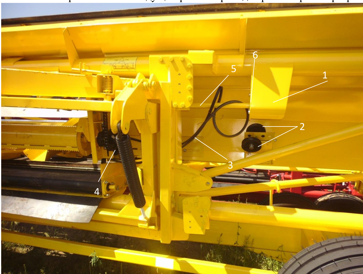
Рис.14 Привод правого транспортера.
