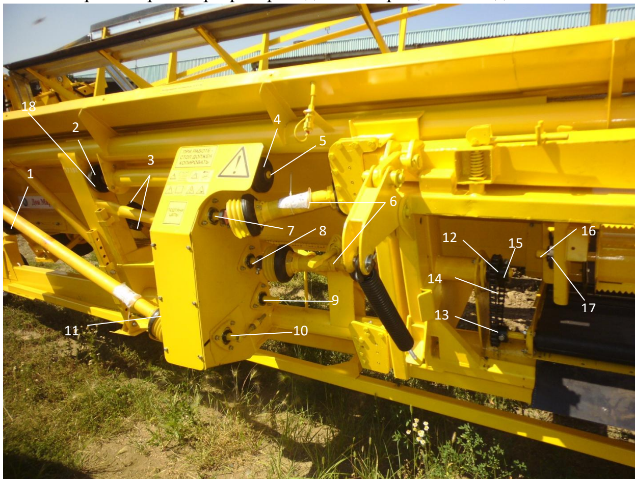
Рис.15 Привод левого транспортёра и центрального стола.
