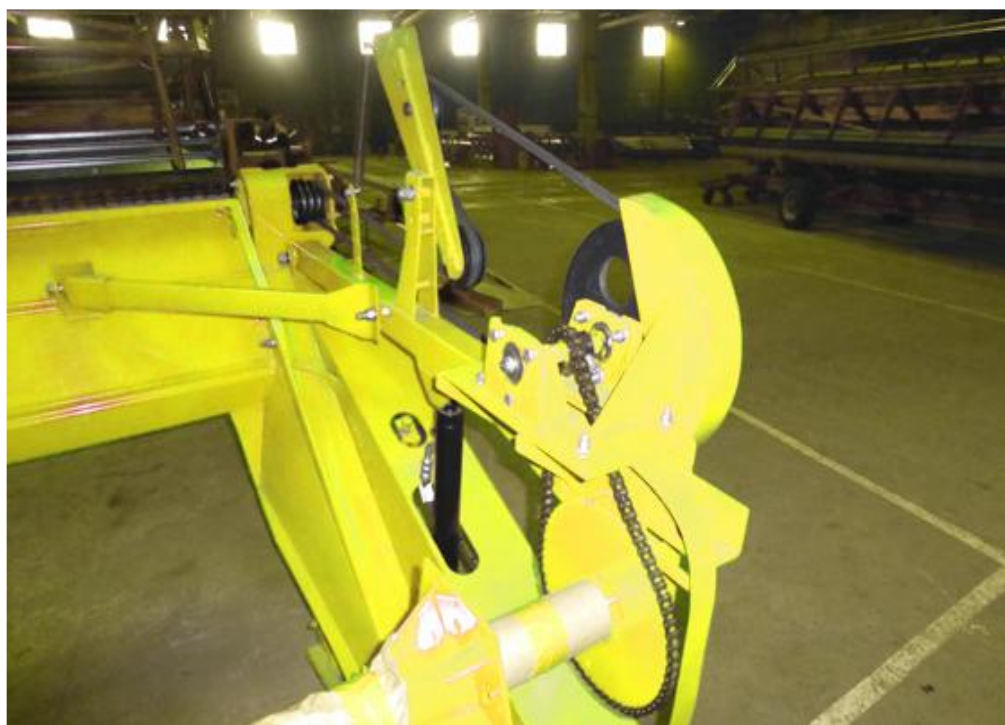
Рис. 6 Механизм привода мотовила
