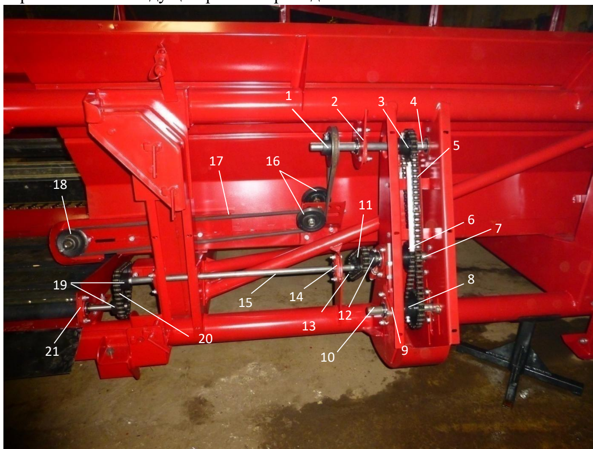
Рис.14 Привод правого транспортёра и центрального стола.
