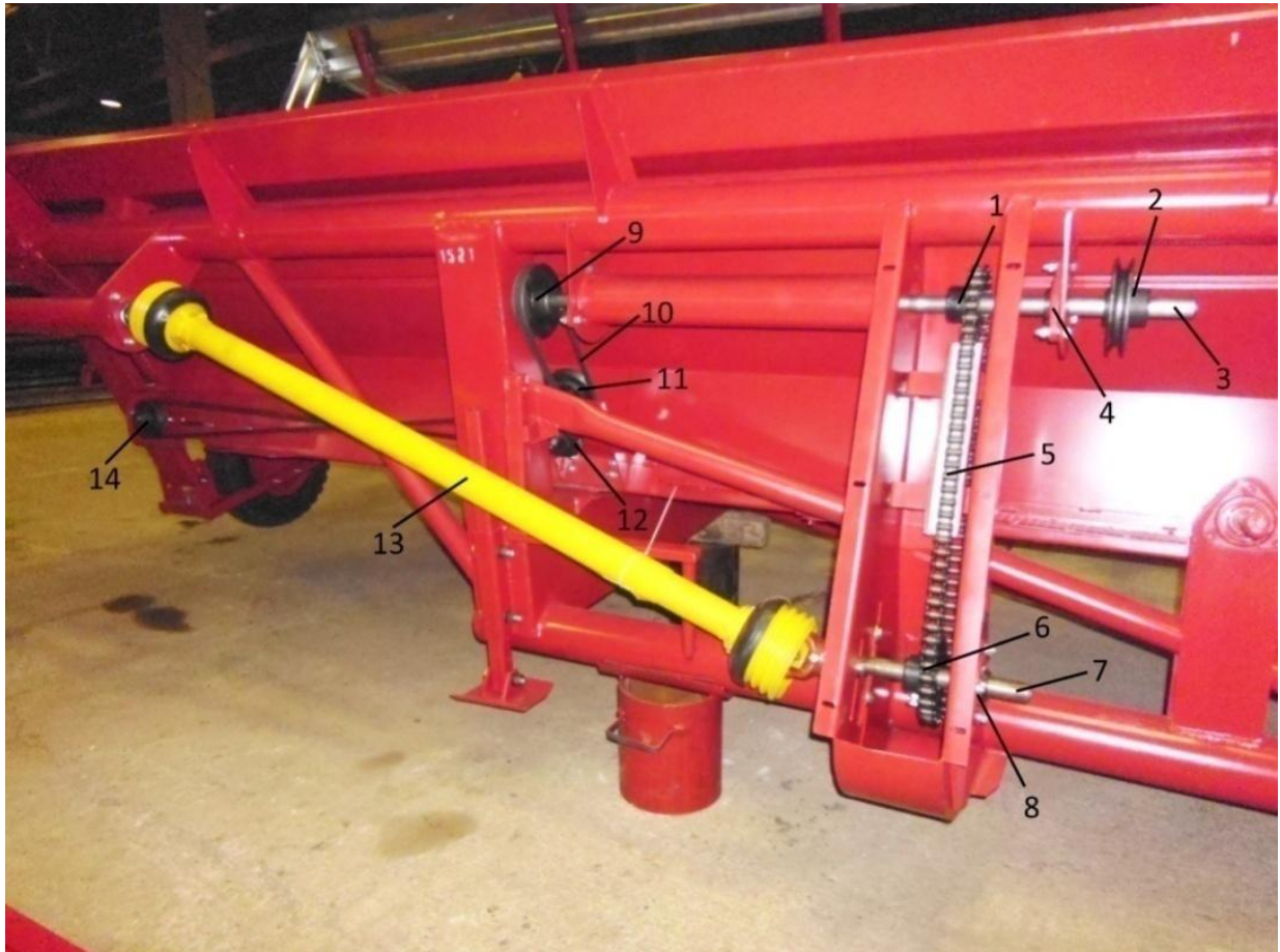
Рис.15 Привод левого транспортёра.
