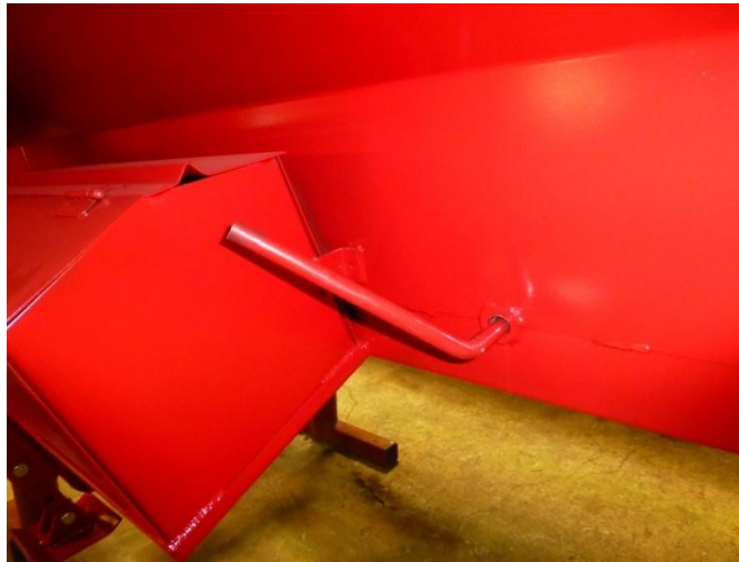
Рис.10 Рычаг натяжения ленточного транспортёра.
