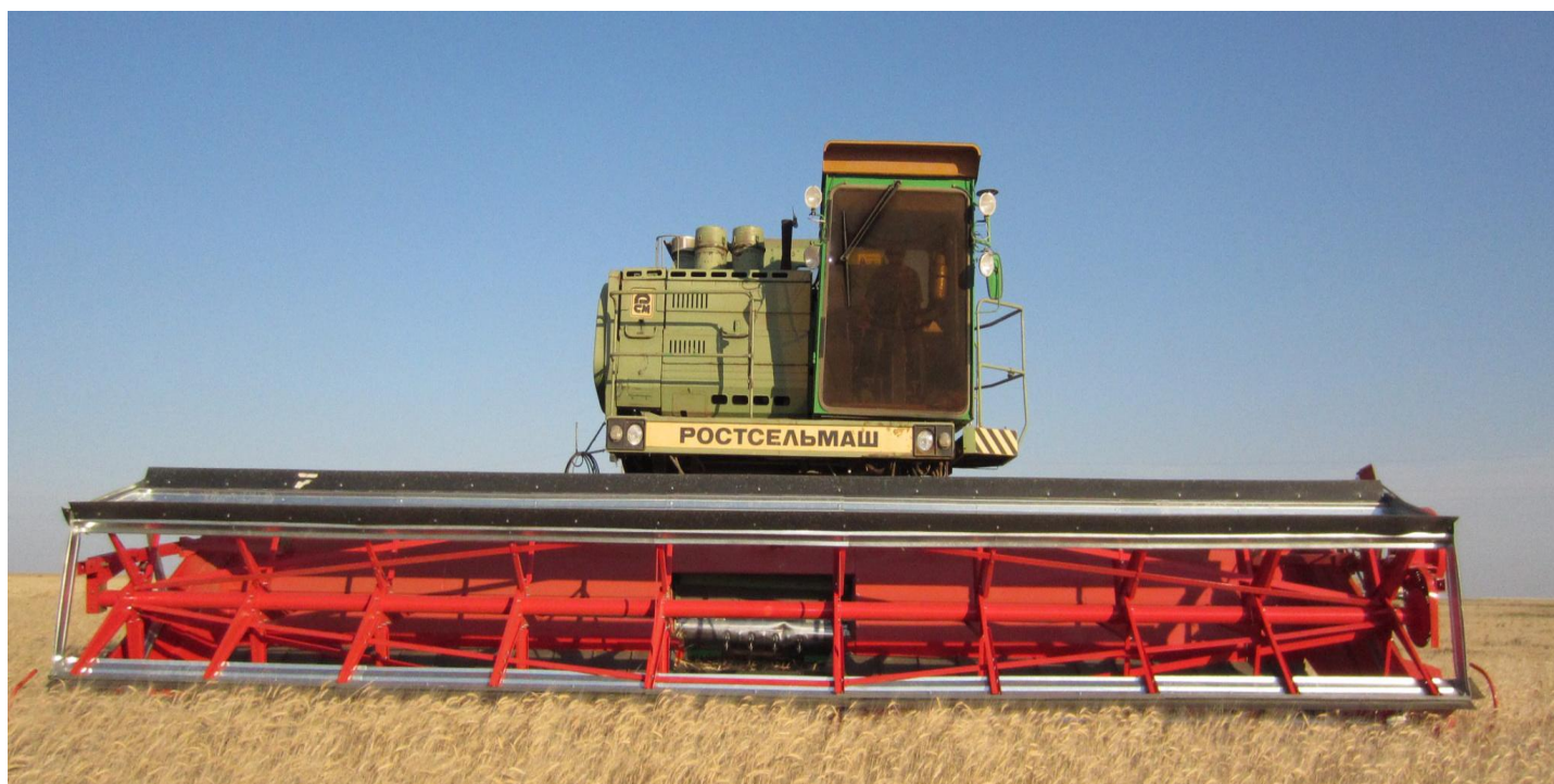
Рис.1 Общий вид комбайна Дон с жаткой «Дон Мар» ЖН-9У(Д)
