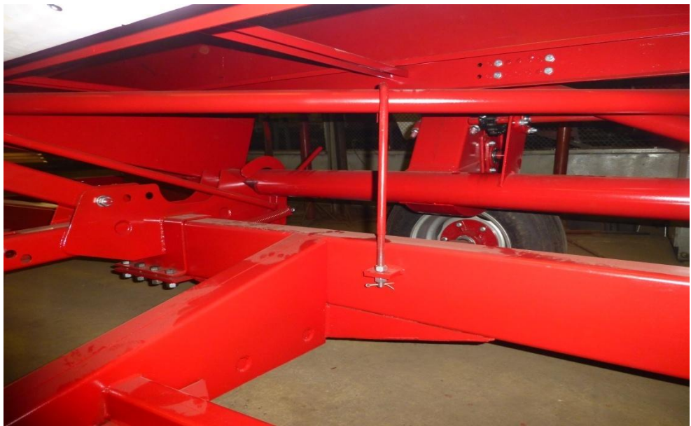
Рис.30 Крепление жатки на тележке.
