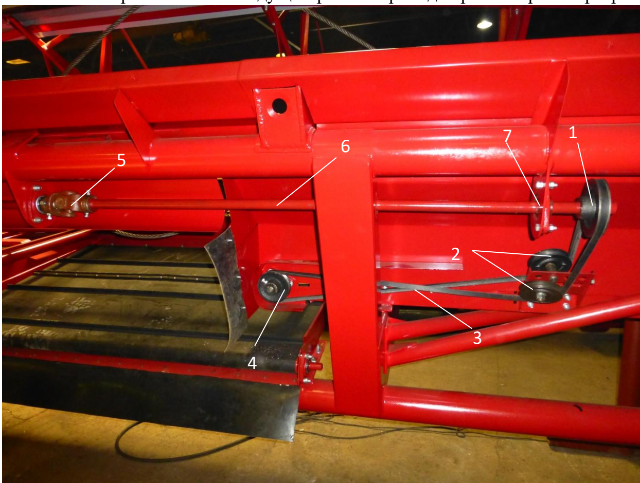
Рис.14 Привод правого транспортёра.
