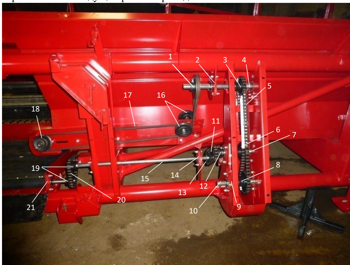
Рис.14 Привод правого транспортёра и центрального стола.
