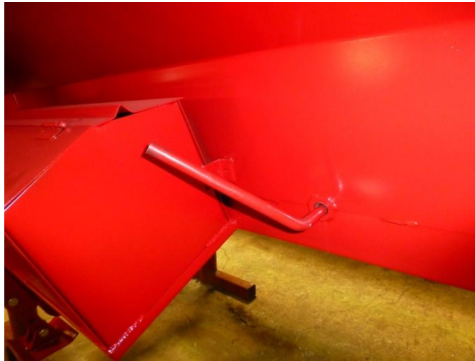
Рис.10 Рычаг натяжения ленточного транспортёра.
