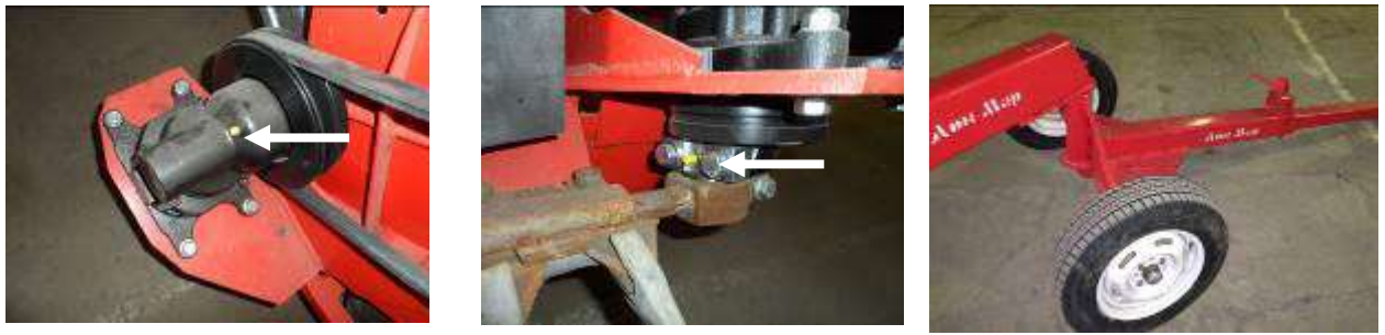
Рисунок 19. Схема смазки жатки
