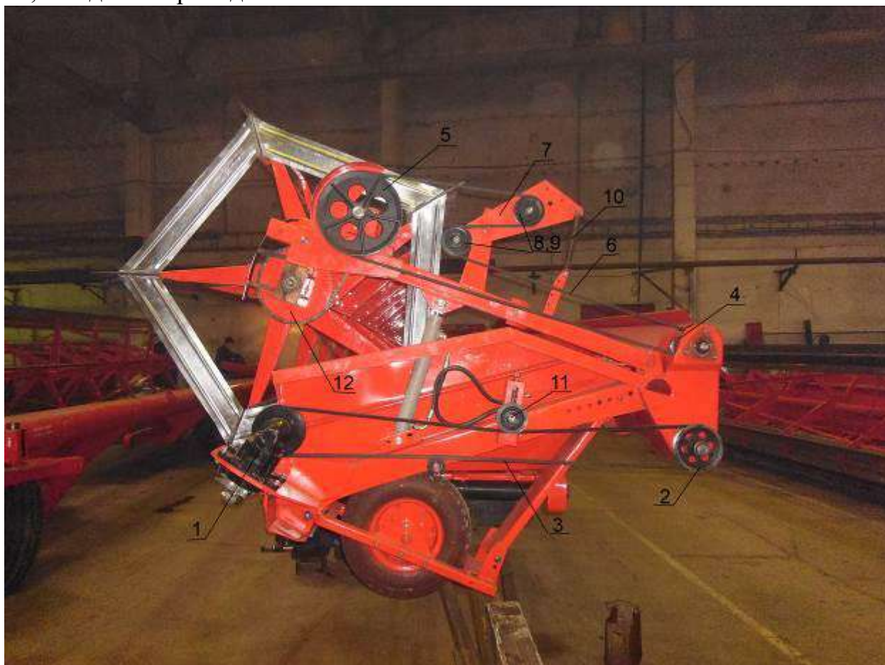
Рисунок 8 – Привод мотовила и режущего аппарата 1) Привод ножа Шумахер 14811.01 Pro Drive 85MVv GKF; 2) ведомый шкив D200; 3) ремень 3750 С(В); 4) трехручейный шкив ЖН12Es-760.169; 5) Ведомый шкив ЖН12Es-760.280; 6) ремень 4250 В(Б), 7) коромысло, 8,9) натяжные шкивы ЖН12Es-760.755; 10) пружина, 11) натяжной шкив ЖН12Es-760.753; 12) звездочка привода мотовила ЖН12Es-760.392.
