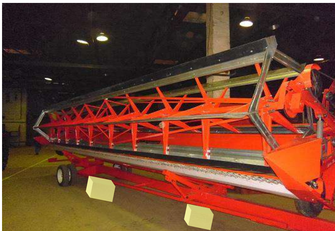
Рисунок 20. Схема постановки на длительное хранение жатки
