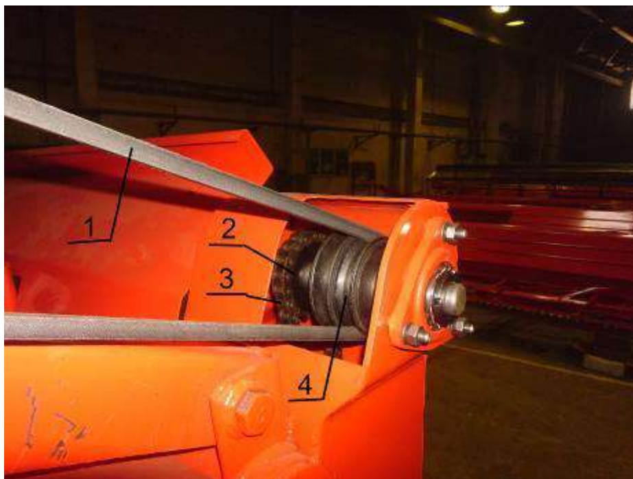
Рисунок 14 – Регулировка оборотов мотовила
