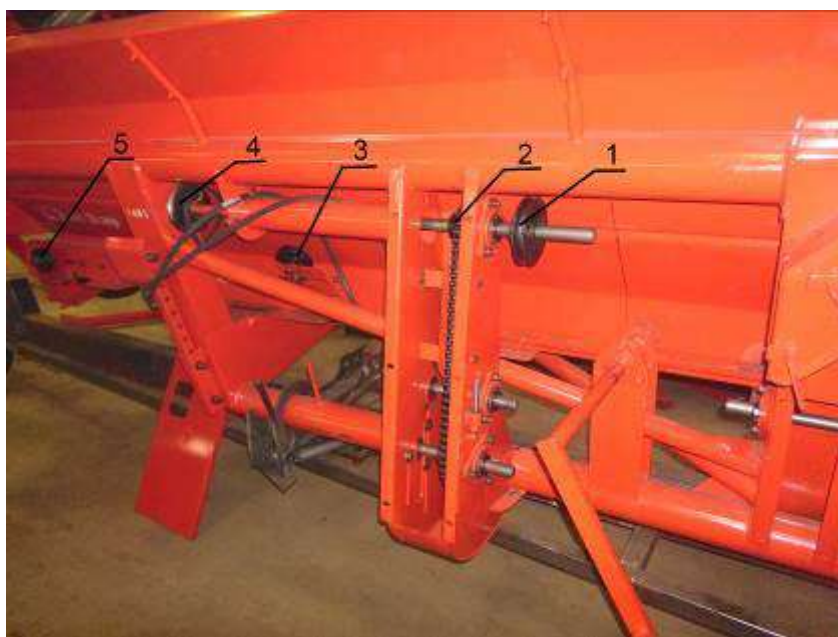
Рисунок 13 – Привод левого транспортера
