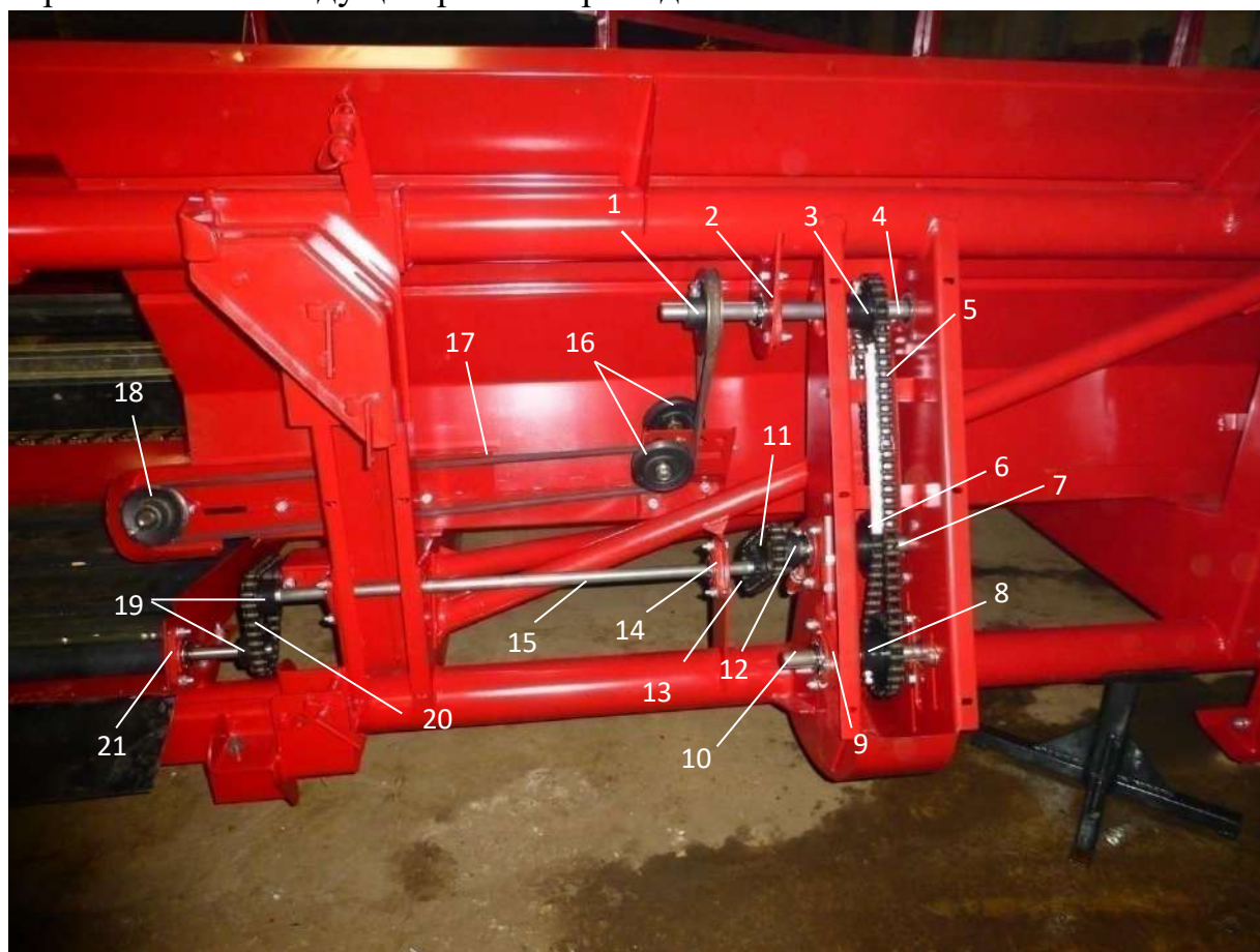
Рис.14 Привод правого транспортёра и центрального стола.
