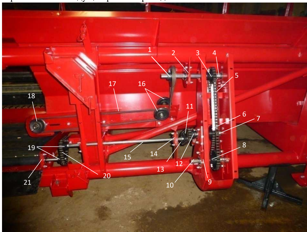
Рис.14 Привод правого транспортёра и центрального стола.
