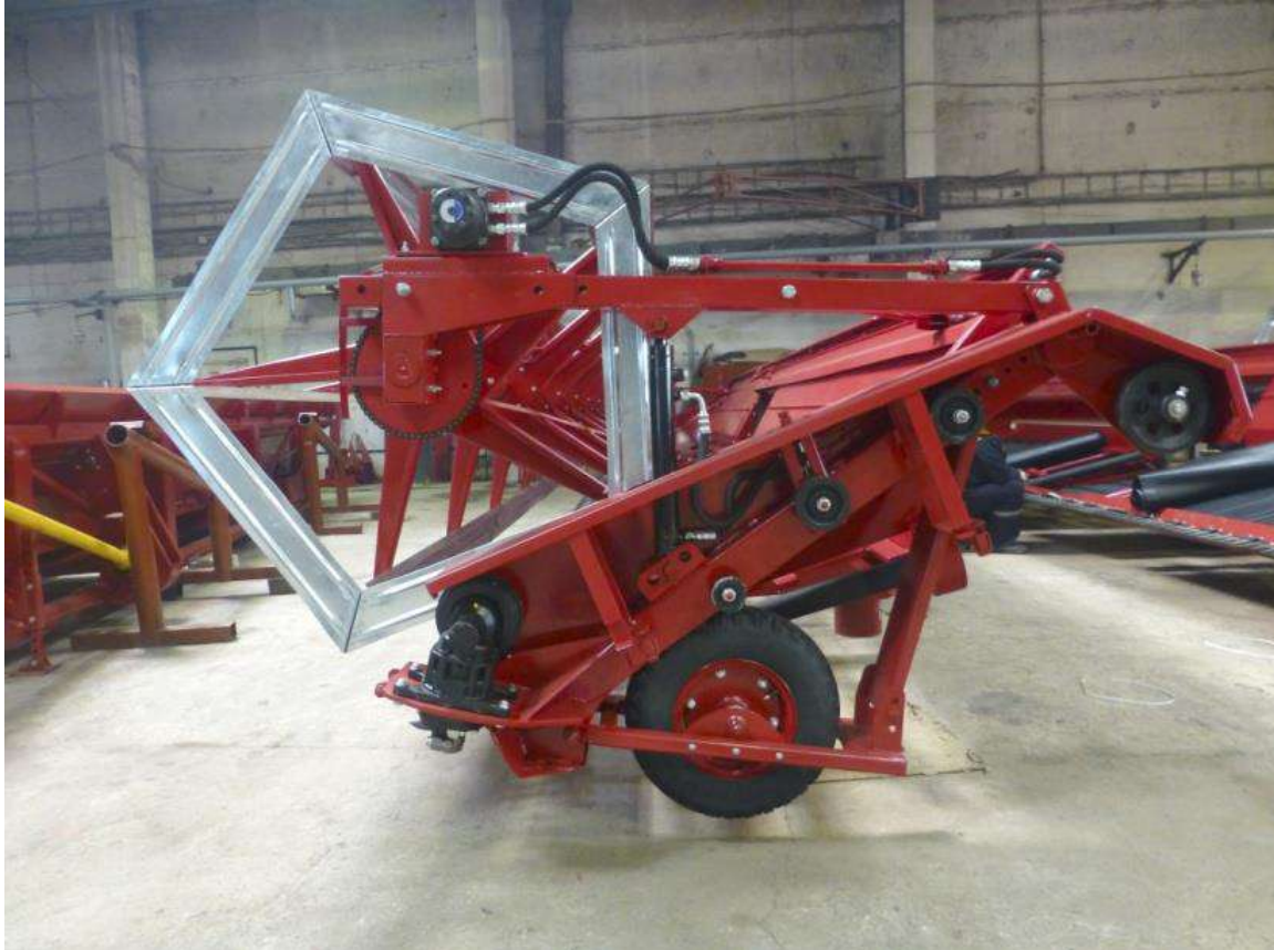
Рис. 3 – Опорные колеса 1- шина 5.00-10 В-19АМ Барнаул; 2- Стенка колеса ЖН9.236 СБ; 3- Рама колеса ЖН9.237 СБ; 4- диск колеса с\х;
