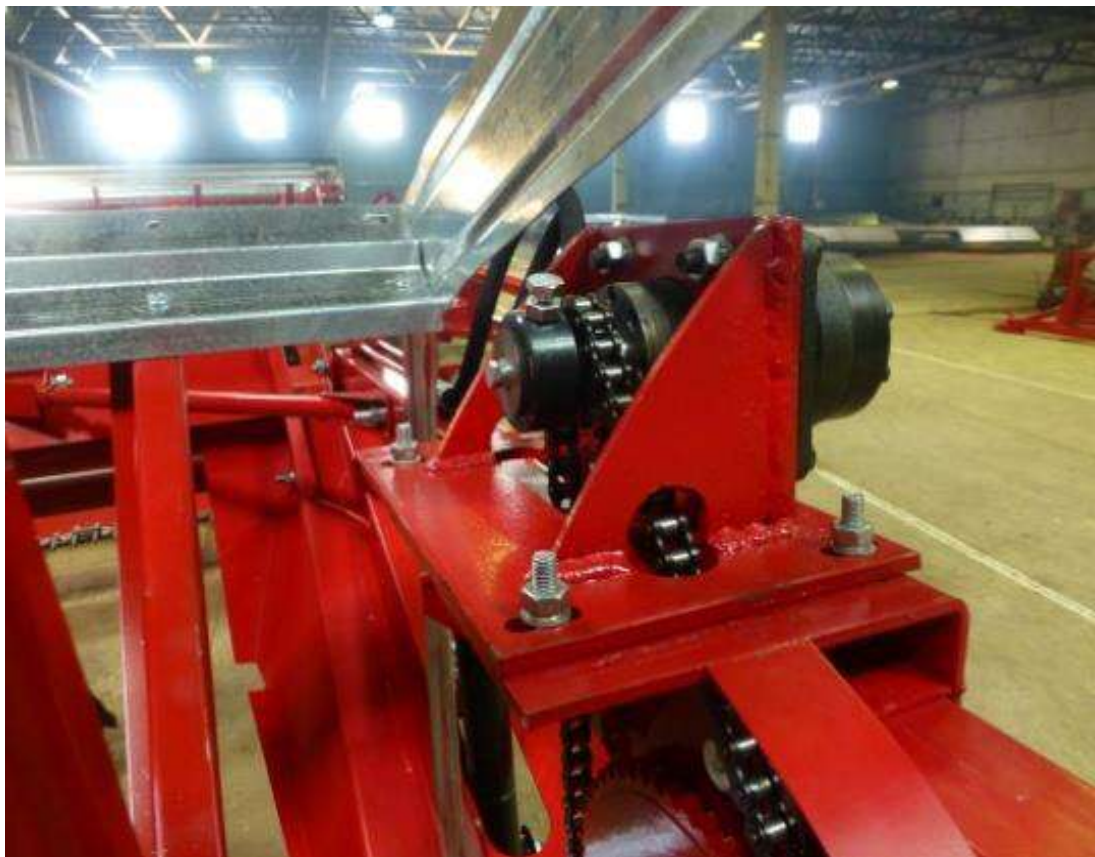
Рис. 6 Механизм привода мотовила
