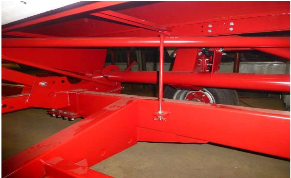
Рис.22 Крепление жатки на тележке.
