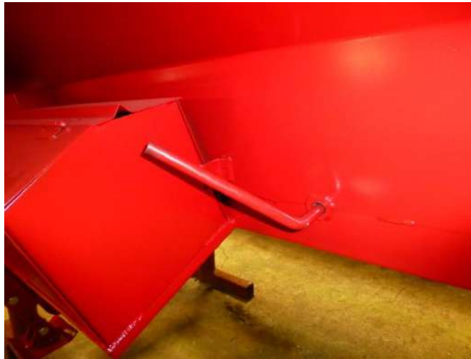
Рис.10 Рычаг натяжения ленточного транспортёра.
