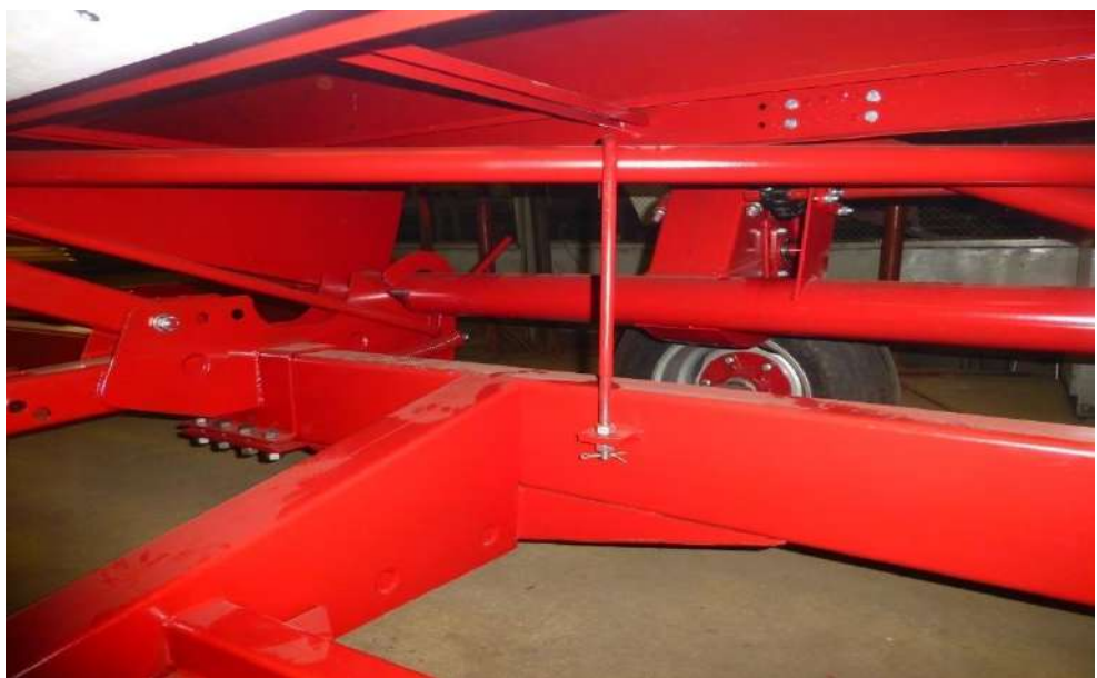
Рис.28 Крепление жатки на тележке.
