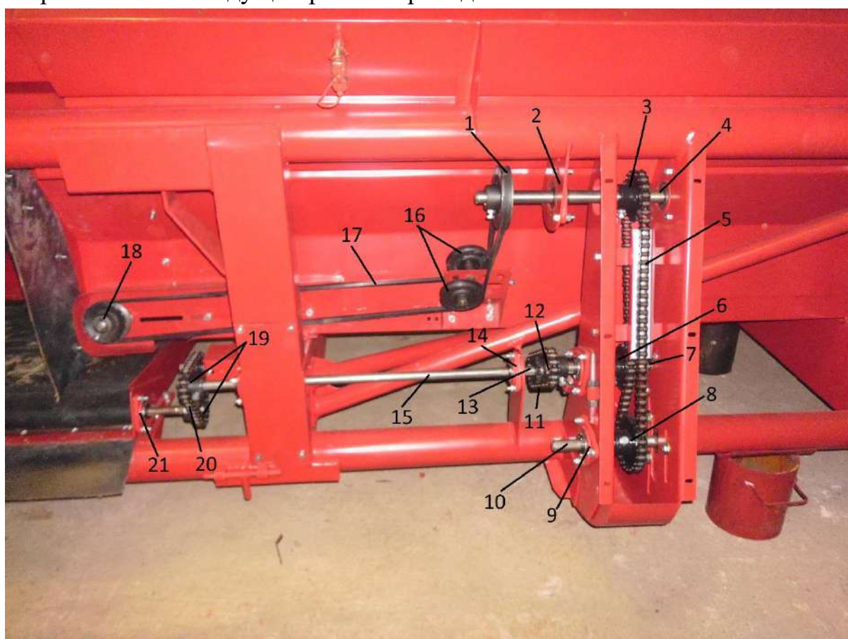
Рис.14 Привод правого транспортёра и центрального стола.
