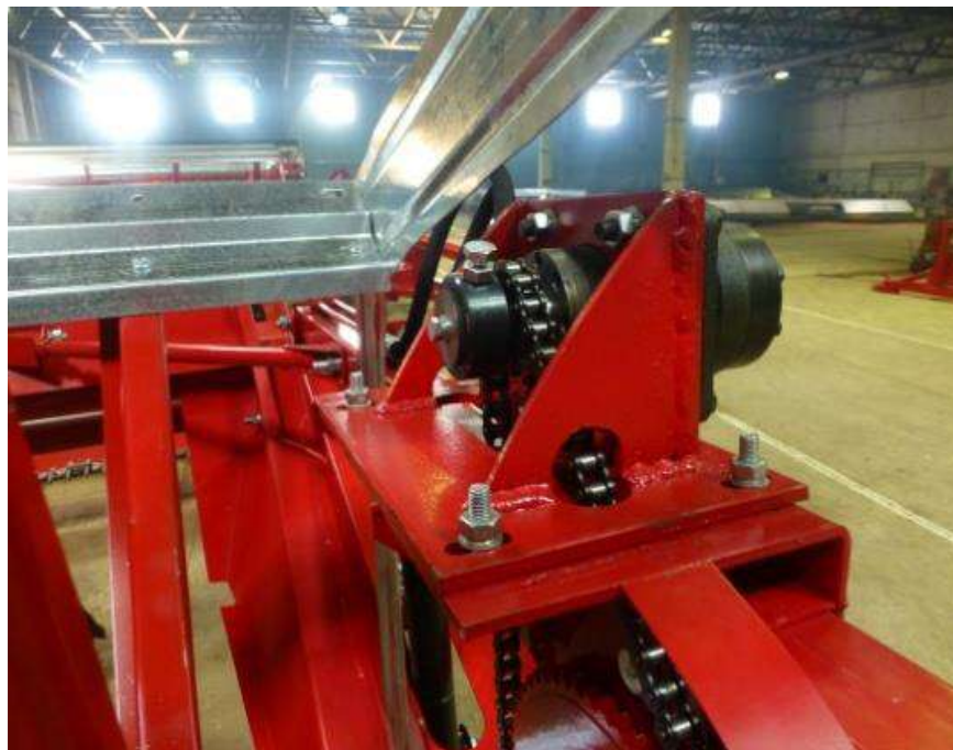
Рис. 6 Механизм привода мотовила
