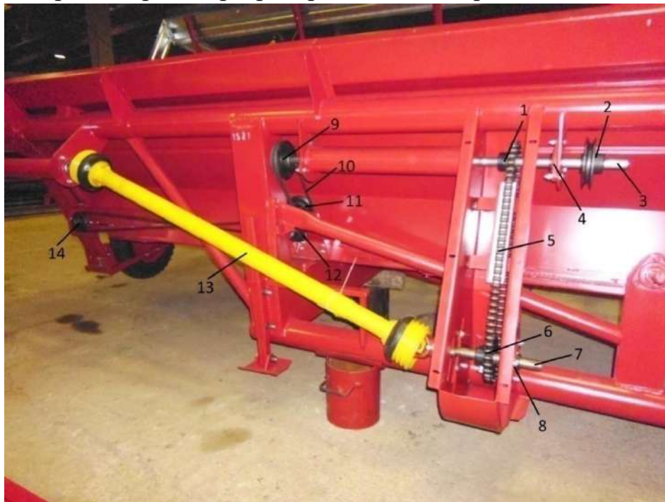
Рис.15 Привод левого транспортёра.
