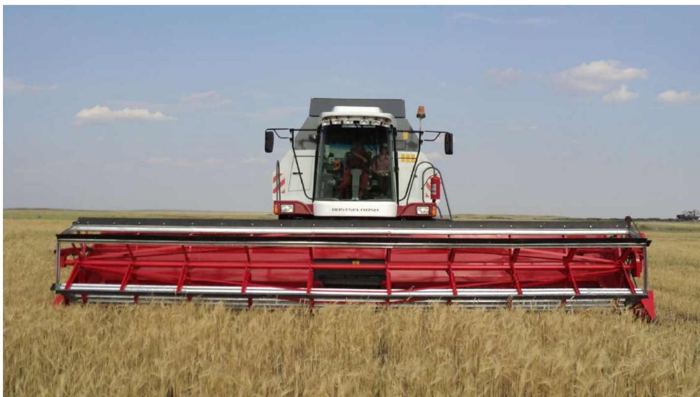
Рис.1 Общий вид комбайна Вектор с жаткой “Дон Мар 7Вну”
